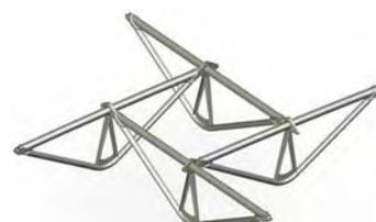
La manutention est facile : deux hommes seuls peuvent mettre en place la structure en disposant les poutres à 90° les unes sur les autres. Le principe de lestage est peu commun, autant dans l'utilisation des gabions de terre remplis d'amphores que dans les lests suspendus. Ainsi, Paul Andreu propose une réponse complète aux cahiers des charges tout en incarnant une écriture contemporaine qui enrichit la lecture du site naturel
